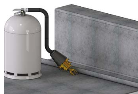
3. Překrýt první vrstvu svislou asfaltovou podkladního pásu
