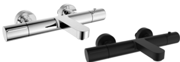
Termostatická nástěnná vanová baterie, Oudee montáž na stěnu rozteč 150 mm bezpečnostní záračka při 38 °C přepínání vana / sprcha
