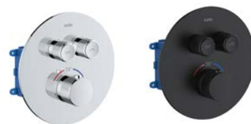
Termostatická baterie pod omítku včetně tělesa, Oudee pro 2 spotřebiče, ovládání pomocí tlačítek, možnost regulace průtoku krycí deska z nerezové oceli instalace na montážní těleso, které je součástí dodávky
