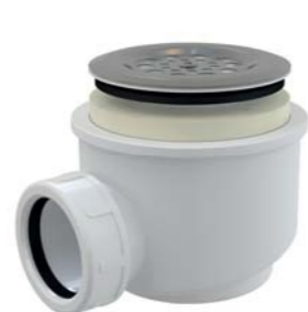
A46-60 Sifon vaničkový, pro otvor 60 mm, DN 40, mřížka Ø 86 mm, kov, nerez-lesk
