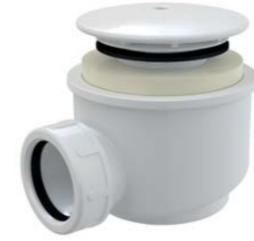
A47B-60 Sifon vaničkový, pro otvor 60 mm, DN 40, krytka Ø 91 mm, plast, bílá-lesk
