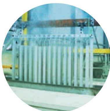
Galvanovna RAVAK Eloxování hliníkových profilů - výroba nejodolnějších profilů sprchových koutů, dveří a vanových zástěn.
