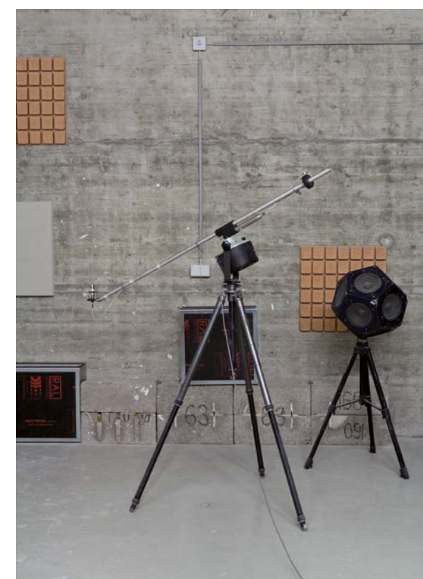
Zvukové izolační testy koupelnových stěn TECE v Institutu fyziky budov ve Franhouferu. Je předvídaté mít nízkou úroveň hluku v hotelech, ale to samé platí pro soukromé byty. V TECEprofil jsou použity speciální zvuk absorbující prvky pro zajištění nízké úrovně hluku. Nezávislé zprávy potvrzují snížený přenos zvukových vln a vibrací konstrukční strukturou dané budovy.
