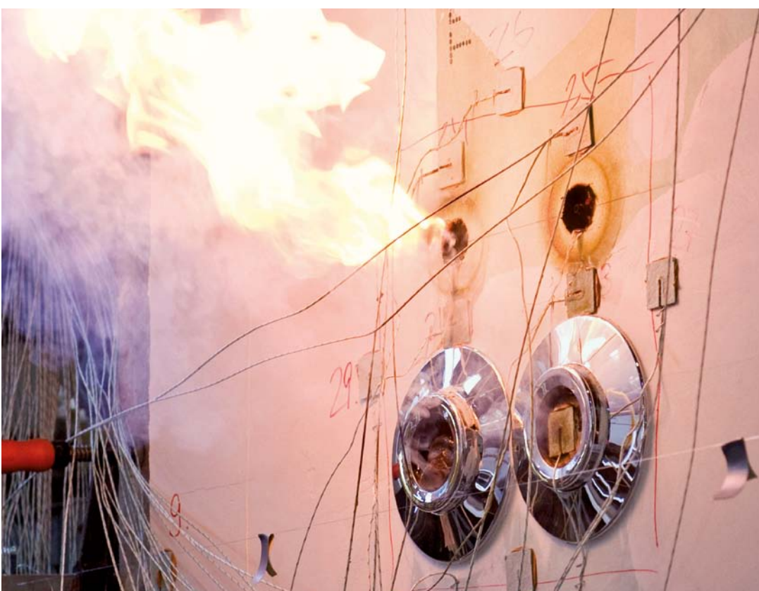
Zkouška požární odolnosti v německém Institutu materiálového testování v Braunschweigu. V závislosti na konstrukci stěny, byly při vystavení otevřenému ohni dosaženy třídy ohnivzdornosti až do hodnoty F 120.
