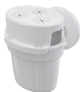
AKS5 Nálevka se sifonem DN 32 pro odkapávající kondenzát, s kuličkovou suchou zápachovou uzávěrou a držákem hadiček
