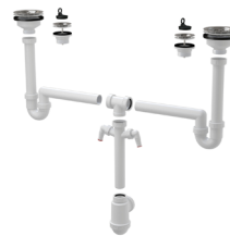
A8000 Sifon pro dvoudřez DN 40/50 univerzální s dvěma přípojkami Ø 17-23 mm, nerezové mřížky Ø 70 mm a Ø 115 mm, pryžová zátka
