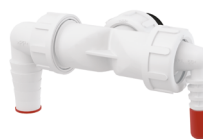
P156Z-G1 Dvojité kolínko G 1" x Ø 8-23 mm pro napojení pračky a sušičky na sifon, se zpětnými klapkami
