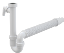
A83-DN50/40 Sifon trubkový dřezový DN 50/40 s přípojkou Ø 17-23 mm, převlečnou maticí G 6/4" a flexí hadicí
