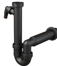
A81-DN50-ECO Sifon trubkový dřezový DN 50 s přípojkou Ø 17-23 mm a převlečnou maticí G 6/4"
