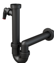
A81-DN40-ECO Sifon trubkový dřezový DN 40 s přípojkou Ø 17-23 mm a převlečnou maticí G 6/4"
